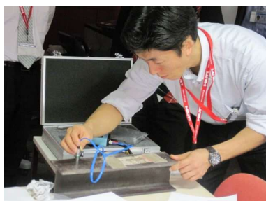
鋼材厚さ測定器の実技状況
