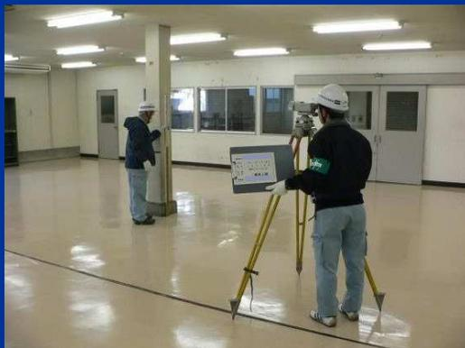
写真3-7 一等水準儀による不同沈下測定
