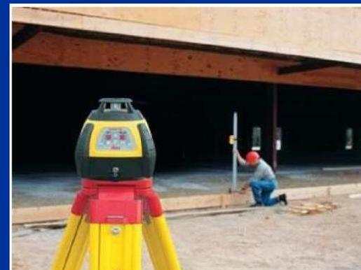
写真3-8 レーザーレベルによる不同沈下測定(1人での測定可)
