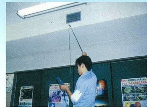
換気風量測定
