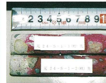
小径コア表面の中性化試験
