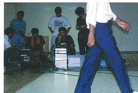
人の歩行による床の振動測定
