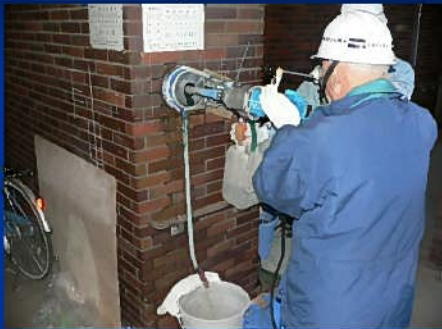
コンクリートコアの抜き取り中
